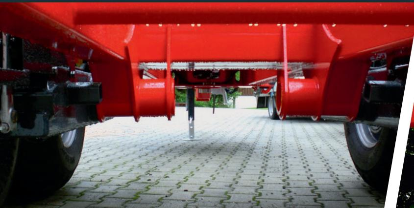
**Rahmen 2 x ausziehbar** 450 mm und 900 mm, einfache Verriegelung und automatische Einrastung des Ausschubs
