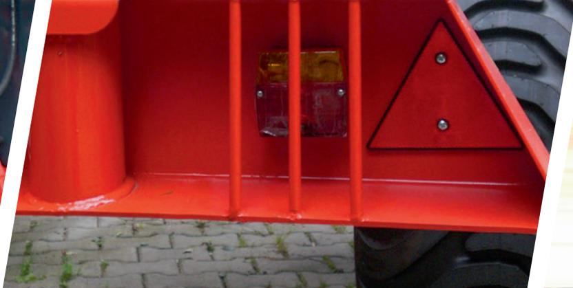
Schutzabdeckung für Druckluftzylinder auf der Bogeachse
