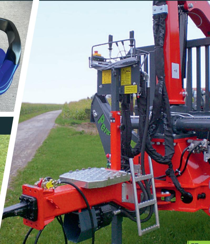
EHC-Steuerung mit Druckfilter (Vorlauf), montiert auf Rückewagen
