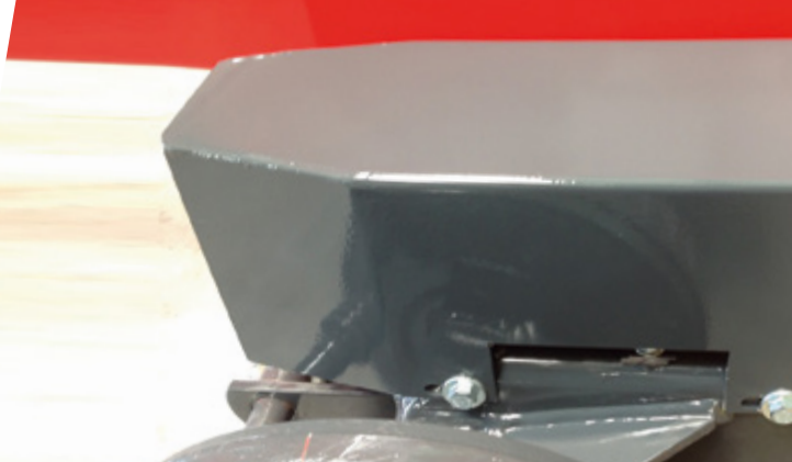
Schutzabdeckung für Druckluftzylinder auf der Bogeachse
