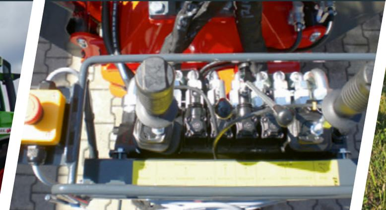
Kabelsteuerung mit zwei Joystickhebeln, Druckknöpfe für Stützfüße, gelbe Schieber für Zange und Ausschub, Umlegschalter für Eilgang und Kriechgang.
