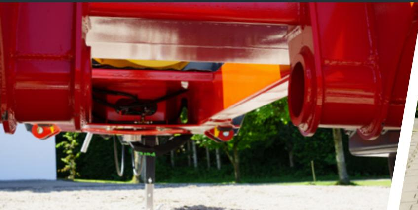
Rahmen 2 x ausschiebbar 450 mm und 900 mm, einfache Verriegelung und automatische Einrastung des Ausschubs
