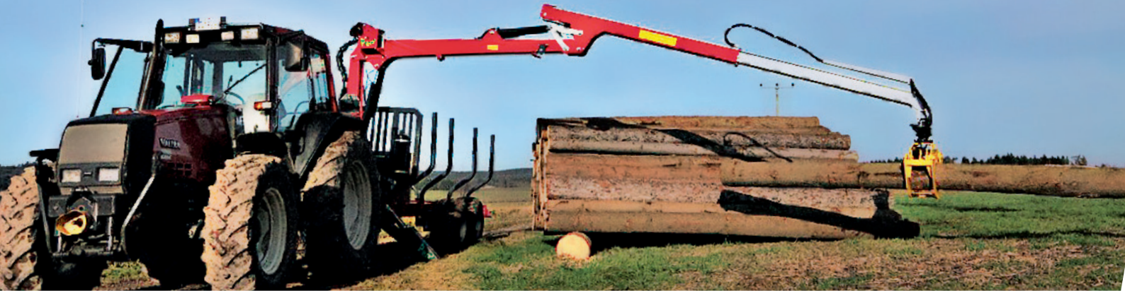
Rückewagen mit aufgebauter Spaltzange (Spaltzange abnehmbar)
