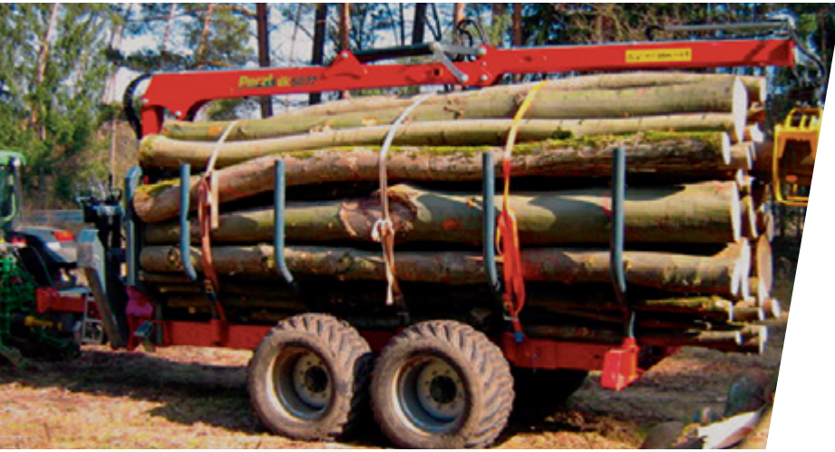
Bereifung 550 x 45 x 22,5 Traktionsprofil
