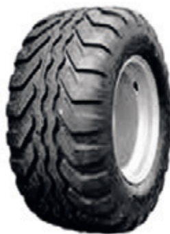
TVS-Reifen mit verstärkten Felgen
