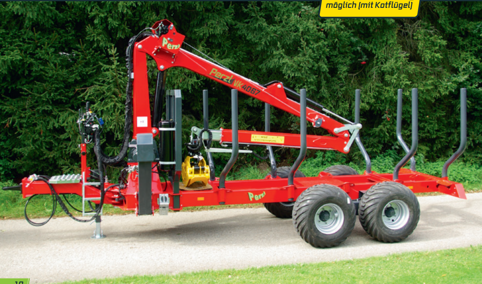
Rückewagen PRW 10 mit aufgebauter Kranfunkwinde
