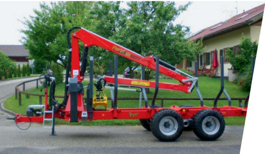
Rückewagen PRW 10 mit aufgebauter Kranfunkwinde
