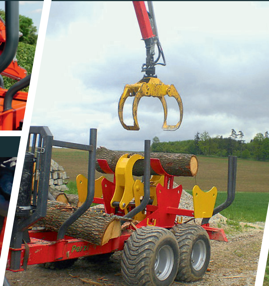
Rückewagen mit aufgebauter Spaltzange (Spaltzange abnehmbar)
