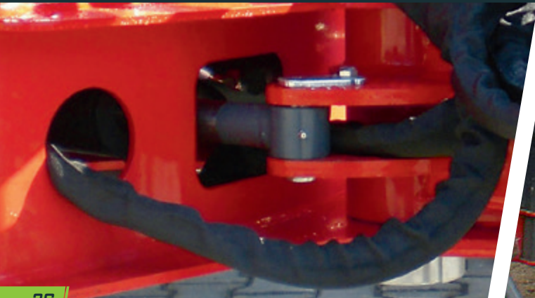
Schwenkdeichsel mit zwei geschützten Zylindern und mechanische Verriegelung für Straßenfahrten
