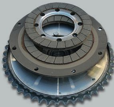
Hochwertig verklebte Kupplungsscheiben (Dreilamellenkupplung bei 6,5 t und 8,5 t)
